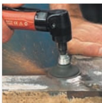
ARRANQUE DE SOLDADURA
