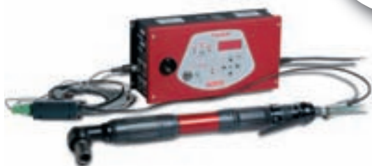
FAS3000 (opcional): Control con PLC externo OK/NOK conteo de lotes
